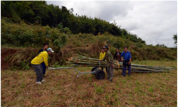
ລໍ່ສອງກົງ ໃຊ້ຊັກລາກໄມ້ປ່ອງ ທີ່ພັດທະນາ ແລະ ຜະລິດຂຶ້ນ ຢູ່ທ້ອງຖິ່ນ ທີ່ສາມາດຂົນສົ່ງໄດ້ເຖິງ 300 ກິໂລກຣາມ.
